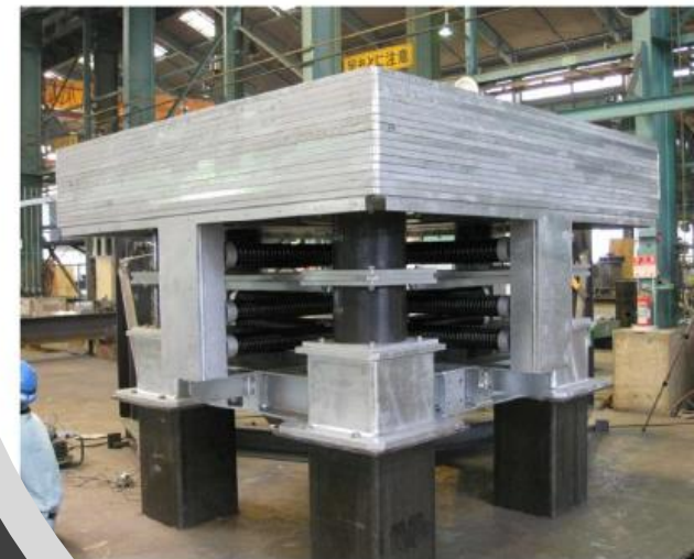
<15ton-TMD> 3m×3m×1.5mH+実験架台
